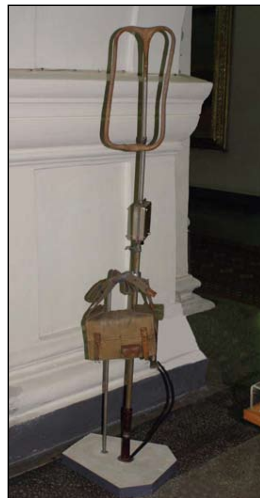
Рис. 3. Миноискатель ИМВЭТА образца 1939 г.
